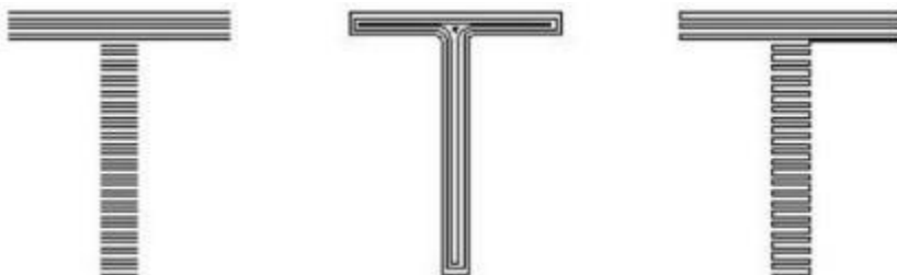
(왼쪽 그림은 단방향 또는 양방향 선형 채우기, 가운데 그림은 리턴 채우기, 오른쪽 그림은 보우 채우기)
